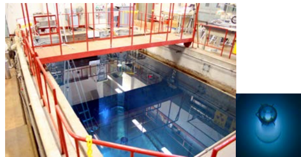
図 1 コバルト 60 ガンマ線照射プールと水中線源からのチェレンコフ光
