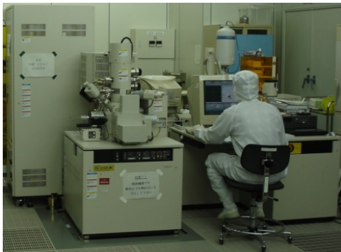
クリーンルーム設置の収束イオンビーム装置。
