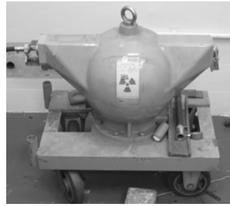
図10 \gamma 線非破壊検査装置
