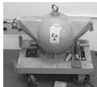
図10 \gamma 線非破壊検査装置
