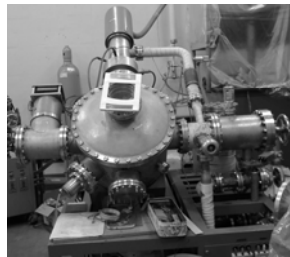
図7 低エネルギー電子線照射装置（100keV）
