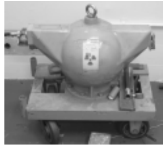
図10 \gamma 線非破壊検査装置、
