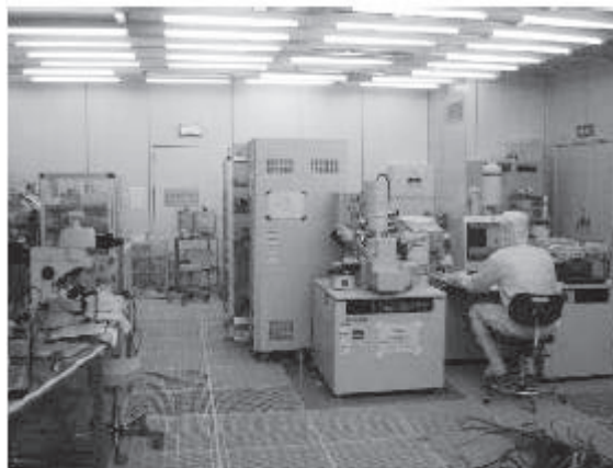
図11 クリーンルーム(クラス1000)室内
