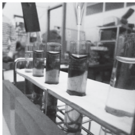
図1. ヨウ化カリウムーデンプン溶液を含んだ水を大気圧プラズマ照射した例
